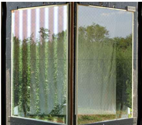
Sicht des Vogels im Versuchstunnel. Pilkington AviSafe™ Aussenansicht: als Schutz vor Vogelprall hoch wirksam, vom Innenraum aus kaum sichtbar (links Prüf-, rechts Referenzscheibe).
