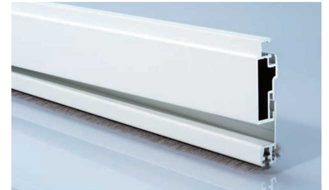
Der im Profil integrierte Multifunktionskanal nimmt die Bürstendichtungen, den schallhemmenden Magnetbandverschluss und die justierbaren 2-Punkt-Scharniere auf.
